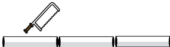
3 Presentar el módulo: Se presenta el tubo de PVC a fin de dimensionar el módulo.
